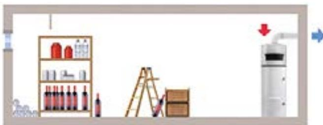
\*En caso de aspirar el aire de un local no climatizado, es necesario disponer de una apertura de aspiración de dimensiones adecuadas.
