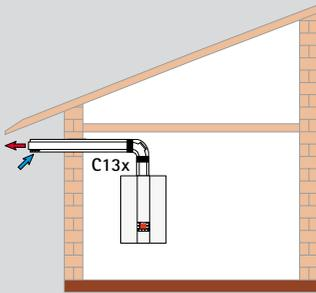
**KIT PARA SALIDA DE GASES HORIZONTAL DN80/125**
