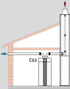
**ADAPTADOR DE CONCÉNTRICO DN80/125 A BITUBULAR DN80/80**
