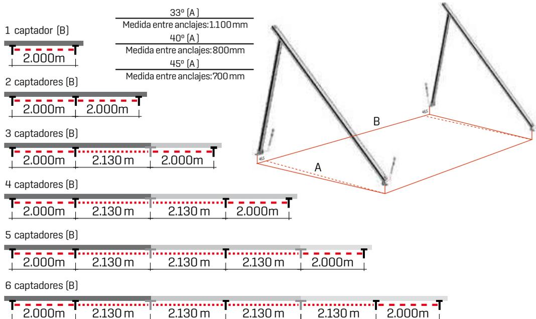
**TOPSON F3-1 Y F3-1Q Máximo 5 captadores a conectar en paralelo**
