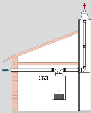
**ADAPTADOR DE CONCÉNTRICO DN80/125 A DN80/80 A BITUBULAR**
