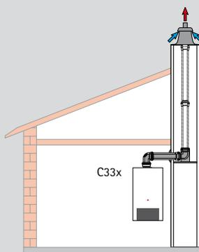
**KIT PARA CONEXIÓN A UN CONDUCTO VERTICAL CONCÉNTRICO**
