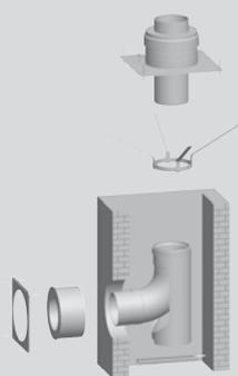
**KIT PARA SALIDAS DE GASES POR PATINILLO/CONDUCTO DE OBRA PARA TIPO C33, C53 Y B23**
