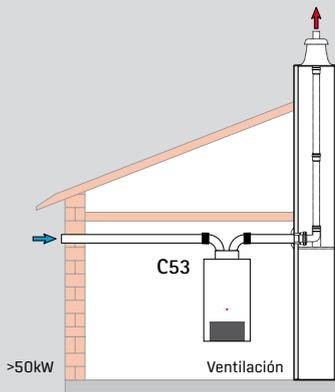
**ADAPTADOR DE CONCÉNTRICO DN110/160 A BITUBULAR DN110/110 admisión/evacuación**
