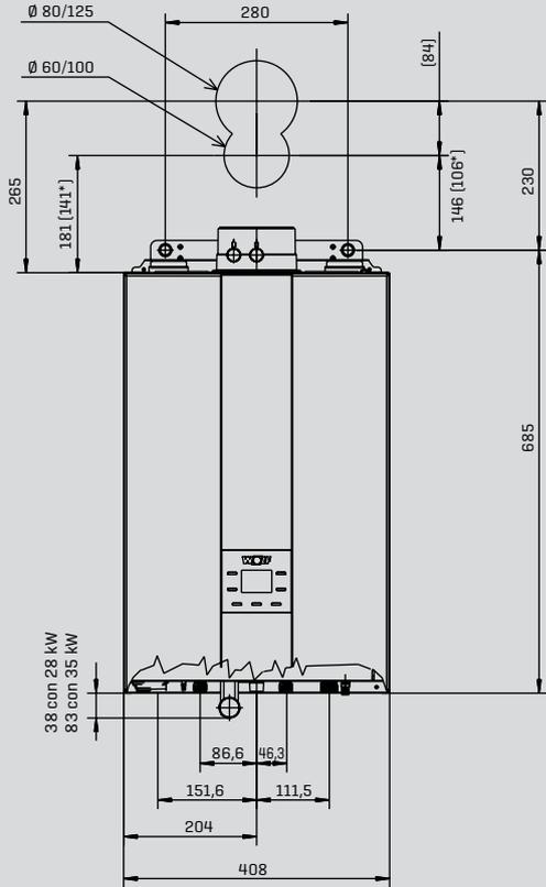
Instalación con brida de conexión 30 mm
