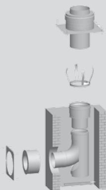
**KIT PARA SALIDAS DE GASES POR PATINILLO/CONDUCTO DE OBRA PARA TIPO C33, C53 Y B23**
