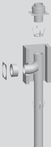
**KIT PARA SALIDAS DE GASES POR PATINILLO/CONDUCTO DE OBRA DN315 CONCÉNTRICO TIPO C33X, C53 Y B23**
