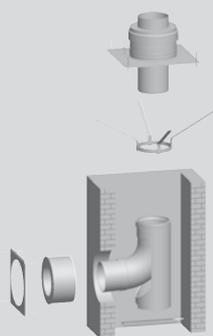
**KIT PARA SALIDAS DE GASES POR PATINILLO/CONDUCTO DE OBRA PARA TIPO C33, C53 Y B23 CON TUBO DE EVACUACIÓN CON TERMINAL**
