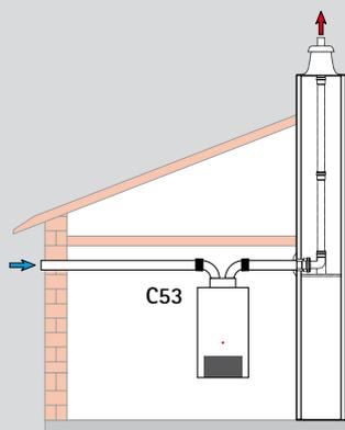
**ADAPTADOR DE CONCÉNTRICO DN110/160 A BITUBULAR DN110/110**
