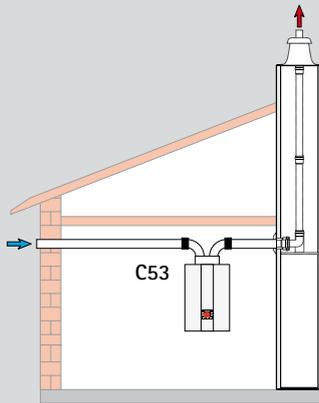
**ADAPTADOR PARA SALIDA DE GASES CONCÉNTRICO DN60/100 A BITUBULAR DN80/80**
