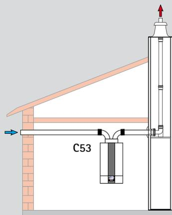
**ADAPTADOR PARA SALIDA DE GASES CONCÉNTRICO DN60/100 A BITUBULAR DN80/80**
