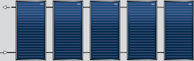
**TOPSON F3-1, F3-1Q Y CFK-1 Máximo 10 captadores a conectar en paralelo**
