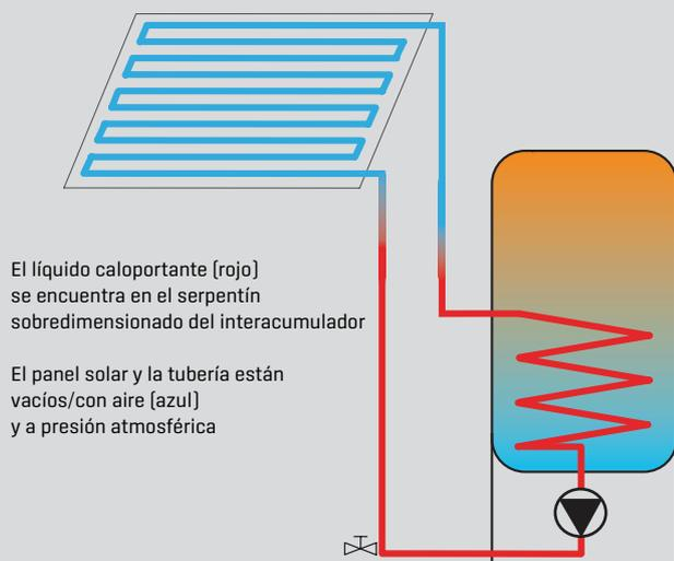
**Instalación en funcionamiento / Bomba ON**
