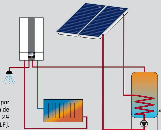
Ejemplo de sistema eficiente WOLF según CTE compuesto por Kit Solar Drain Back y postcalentamiento mediante caldera de condensación a gas mixta CGB-2 K 24 (ampliable con accesorios de regulación y control WOLF).
