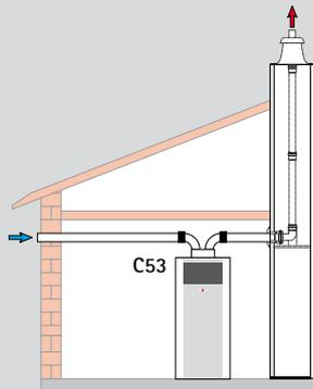
**ADAPTADOR DE CONCÉNTRICO DN110/160 A BITUBULAR DN110/110**
