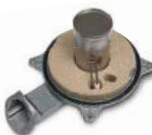
El quemador de premezcla y bajo NOx cuenta con un control de llama por ionización que permite adaptar la combustión modificando la relación de aire/gas con el fin de obtener las menores emisiones contaminantes independientemente de las condiciones ambientales o de instalación.
