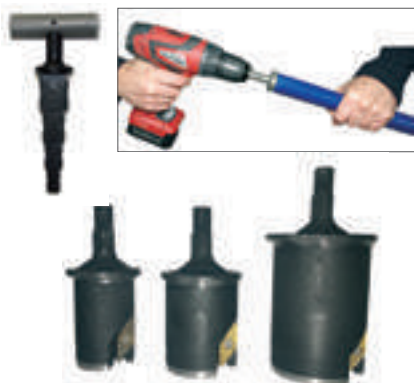
Calibra el diámetro interior del tubo y rebaba la arista para que al montar el accesorio no dañe la junta.
